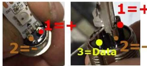
FOR STRIP OR STRING, THE PINOUT IS THE MOST CONVENIENT, YOU CAN SOLDER STRAIGHT TO THE CONNECTOR
